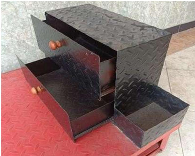
Gambar 37. 1 Buah Laci Tutup dan 2 Kotak Terbuka tempat Meletakkan Peralatan Kerja
