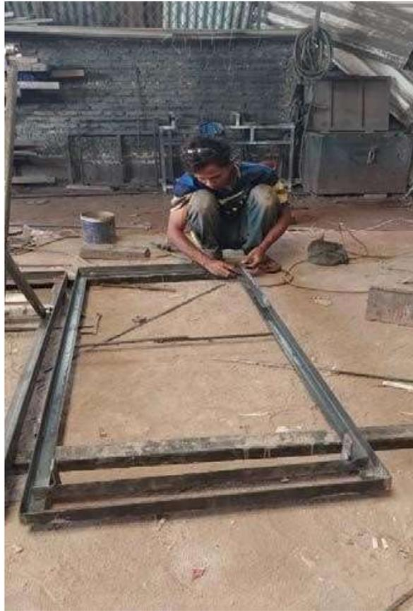
Gambar 28. Perakitan Rangka Utama Menggunakan Baja Hollow 4x34 cm
