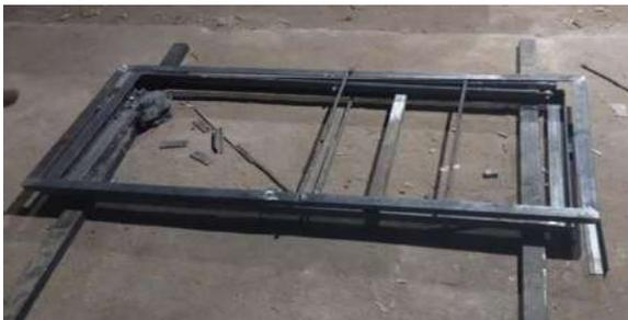
Gambar 7. Pembuatan Rangka Utama
