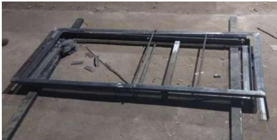
Gambar 29. Rangka Alas Meja dan Rangka Bawah
