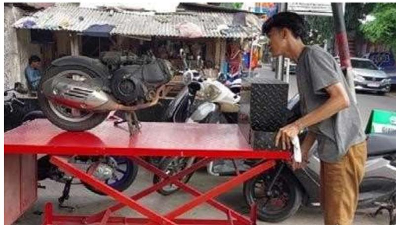
Gambar 11. Implementasi Meja Kerja Service Mesin Motor Matic
