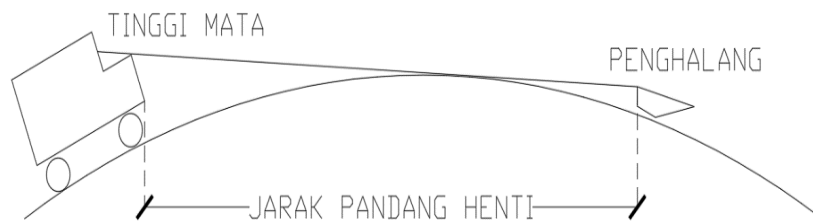
Gambar 3. Jarak pandang henti lengkung cembung
