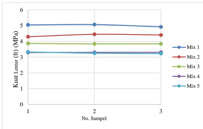
Gambar 3. Grafik hasil pengujian kuat lentur beton
