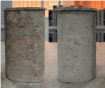
Gambar 3. Gambar sampel beton pasca pembakaran 600°C (kiri) dan sampel beton normal (kanan)
