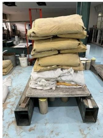
Gambar 2. Pengujian Sambungan Dinding Panel
