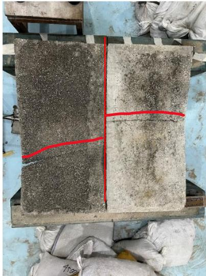
Gambar 5. Pola Kerusakan Pada Sambungan Dinding Panel *Styrofoam* 50%
