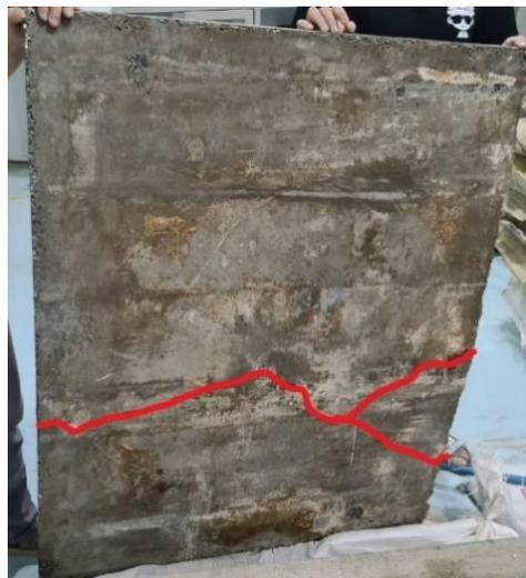
Gambar 8. Tanda pola retak pelat beton ringan dengan perkuatan *wiremesh* 15×15 cm
