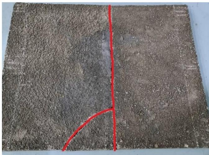
Gambar 6. Tanda pola retak pelat beton ringan tanpa perkuatan *wiremesh*
