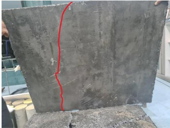
Gambar 7. Tanda pola retak pelat beton ringan dengan perkuatan *wiremesh* 10×10 cm
