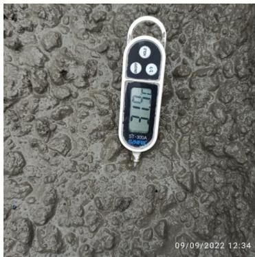
Gambar 1. Pengukuran Suhu Beton
