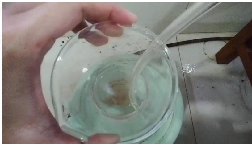
Gambar 3. Pengamatan kejernihan air hasil uji untuk menentukan klasifikasi dispersi
