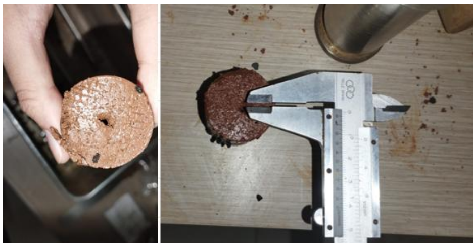
Gambar 2. Pengukuran diameter lubang untuk menentukan klasifikasi dispersi
