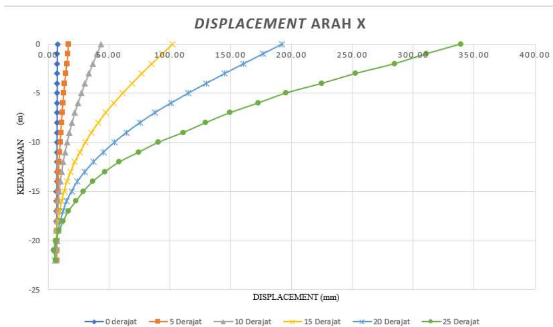
Gambar 6. Perbandingan Deformasi/ Displacement Arah X Setiap Kemiringan Pemancangan Tiang pada Tanah di Sekitar Tiang Batter Pile
