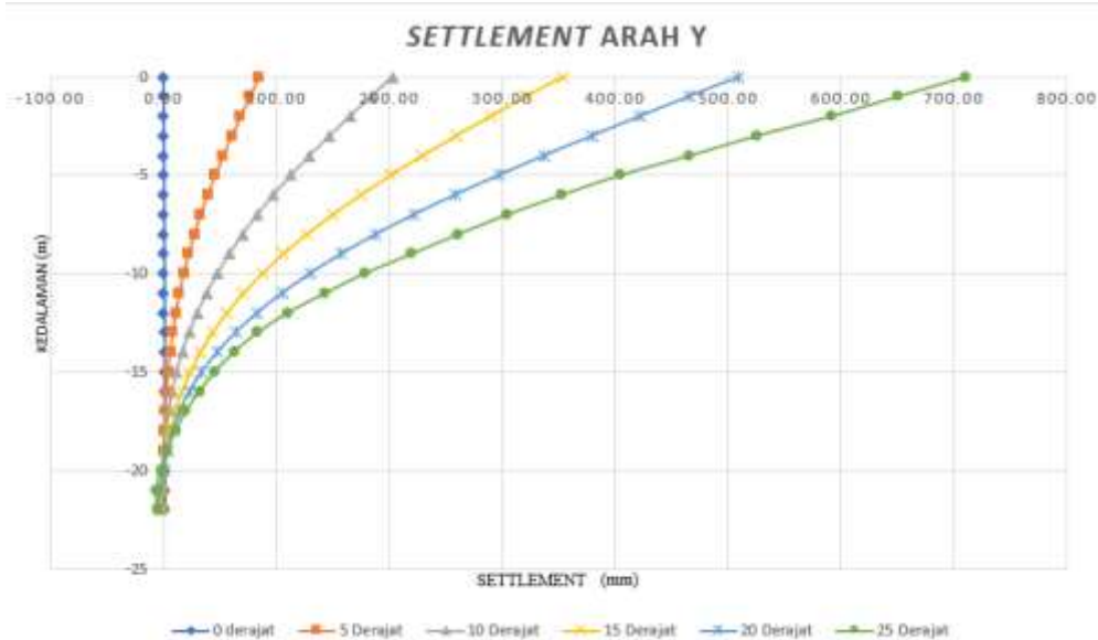
Gambar 7. Perbandingan Settlement Arah Y Setiap Kemiringan Pemancangan Tiang pada Tanah di Sekitar Tiang Batter Pile
