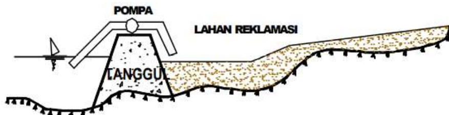
Gambar 3. Reklamasi Sistem Kombinasi antara Polder dan Timbunan. (Sumber: Direktorat Jenderal Pesisir dan Pulau-Pulau Kecil, 2004)
