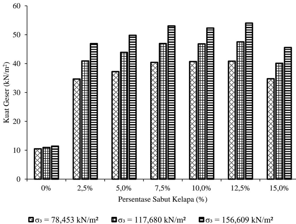
Gambar 2. Diagram perbandingan kuat geser pencampuran tanah dengan sabut kelapa dengan persentase berbeda.
