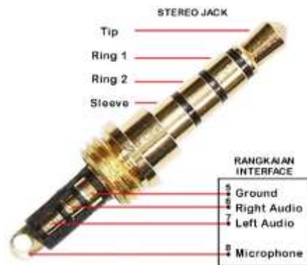
Gambar 7. Koneksi Stereo Jack dan Rangkaian Interface
