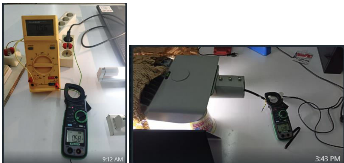
Gambar 15. Kalibrasi alat ukur tang meter dengan multimeter dan kalibrasi arus dan tegangan.
