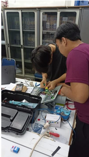
Gambar 1B. Sistem Sensor Diintegrasikan dalam Luminer Lampu PJU
