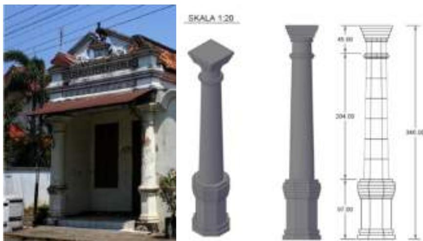
Gambar 4. 24. Detail kolom bangunan.
