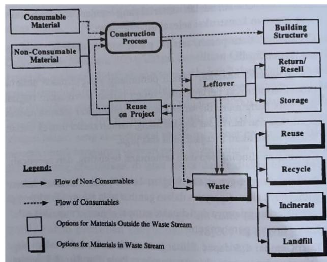
Gambar 1. Aliran dari Material Konstruksi Lapangan (Gavilan & Bernold, 1994)
