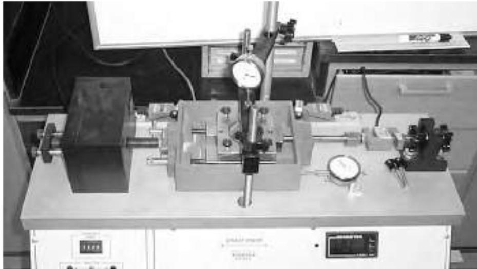
Gambar 11.8. Alat uji *direct shear* (uji geser langsung) [6]
