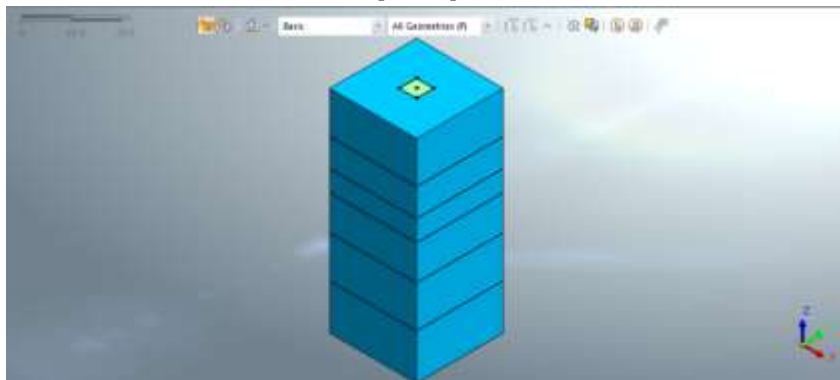
Gambar 7. Pemodelan Pile Group pada Program Berbasis Geoteknik
