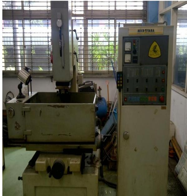
Gambar 6. Mesin EDM
