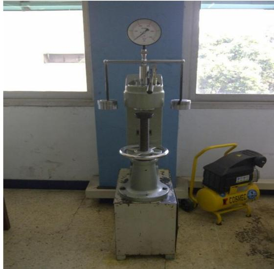
Gambar 8. Alat Uji Kekerasan *Brinell***Spesifikasi:**
