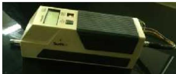
Gambar 4 Alat ukur kekasaran permukaan *surface tester*
