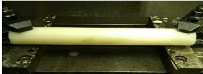
Gambar 2 Bahan benda kerja *polymer ertalone 6 SA*
