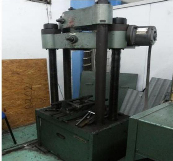
Gambar 5. Alat Uji Tarik Shimadzu
