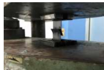
Gambar 5. Proses Uji Tarik Sambungan Spesimen
