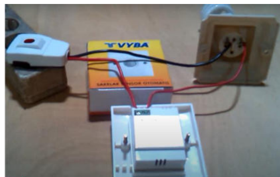
Gambar 3.2 Rangkaian Listrik Sensor PIR antara Saklar dan Beban Lampu
