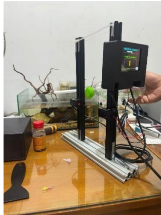
Gambar 4.2 Tampilan Status Sensor Saat Mendeteksi Botol
